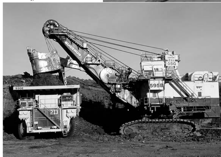
Camión y pala excavadora: 100 toneladas de arenas alquitranadas por carga.
