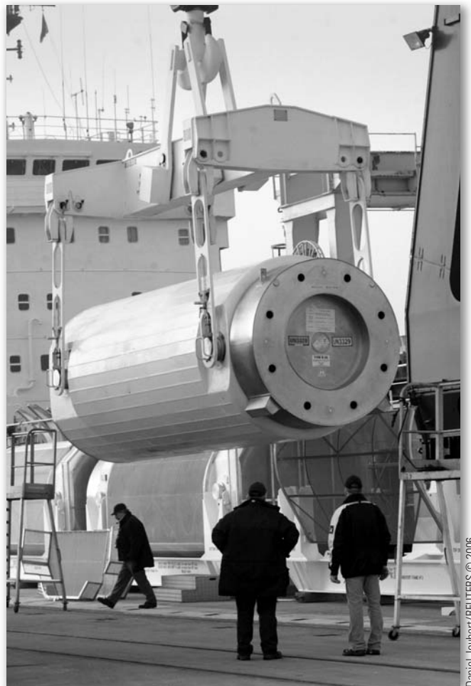
Embarque de un contenedor de residuos nucleares vitrificados en un barco remolcador para su envío desde Cherbourg, Francia, a Japón. El combustible usado de las centrales nucleares japonesas se reprocesa en Francia y después es devuelto a Japón.
