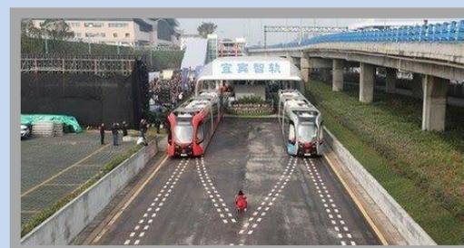
Lo ha hecho en la ciudad china de Yibin, en la provincia de Sichuan, y es allí donde se podrá disfrutar de un tren que no tiene conductor. Funciona de forma autónoma, y lo hace gracias a un raíl virtual que está marcado en el asfalto y que se detecta con una serie de cámaras y sensores especiales, entre los cuales está el ya conocido LIDAR.>
